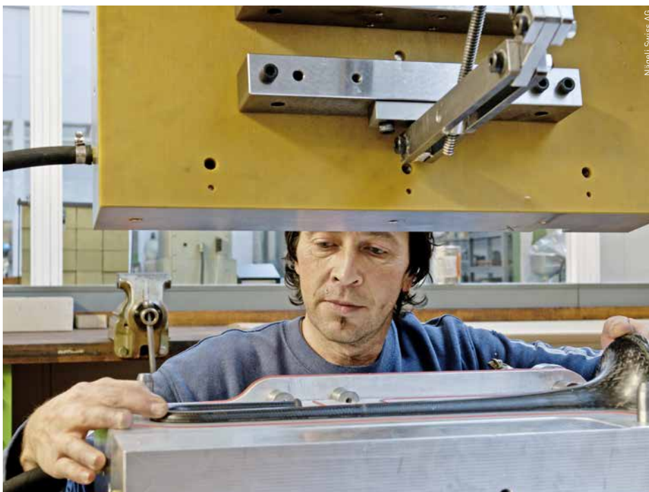
Eine carbonfaserverstärkte Trompete, entwickelt in der Schweiz: Der Schallbecher aus CFK sorgt dafür, dass weniger Energie aufgewendet werden muss, um einen Ton anzuspielen.
