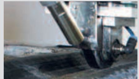
Herstellung eines Dachspiegels mittels Direktablage von thermoplastischen Tapes
